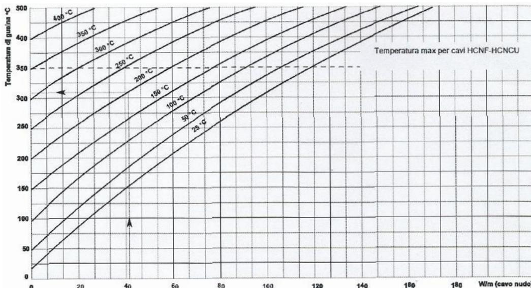
Esempio: cavo tipo HCNF1M 0,4 con potenza di 53 W/m in ambiente a 200°C
