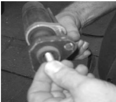
2.) a.) Insert Stud in Welder
